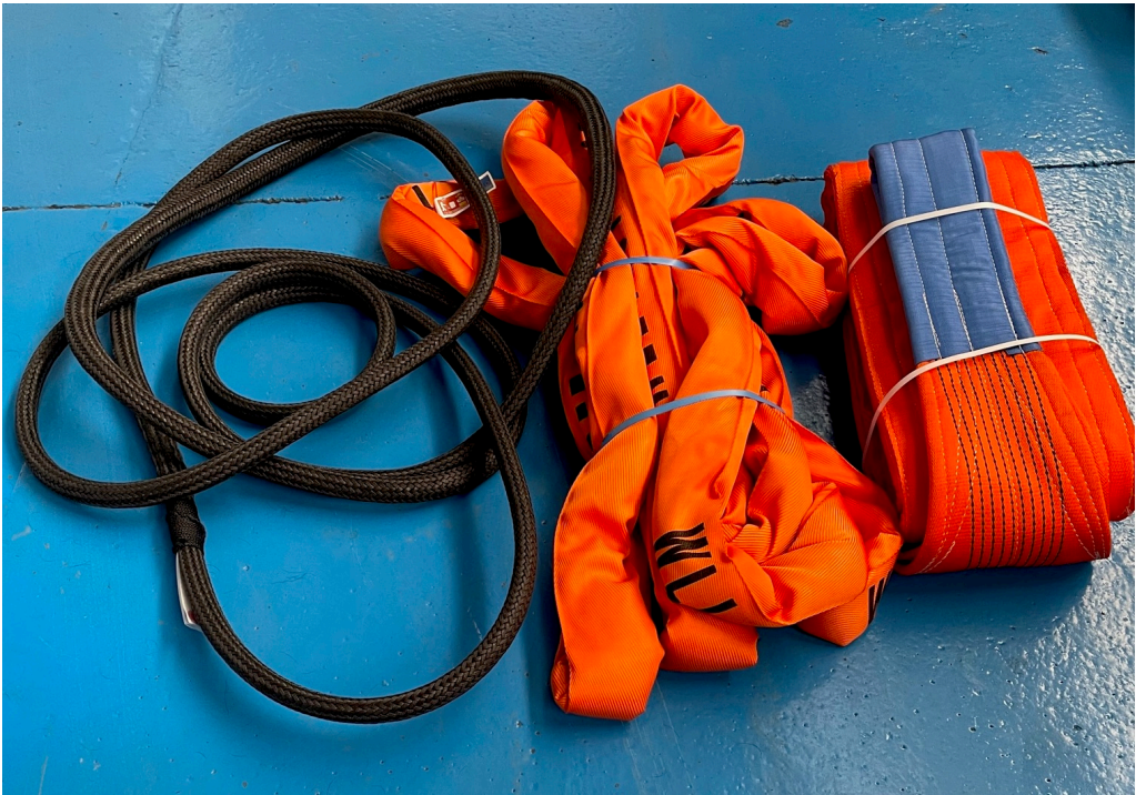
COMPARATIVA 20 TONS: PLANA, TUBULAR, Y ESN SIN FIN CON PROTECCIÓN TOTAL
