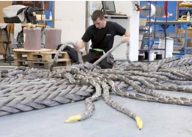
Más allá de los límites: Eslinga de 900 toneladas en proceso de fabricación. Beyond the limits: a megasling with 900t WLL being custom-made
