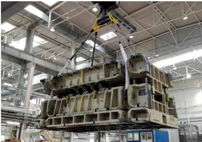
Cambio de prensa para la industria automovilística. Changing of a pressing tool in the auto industry
